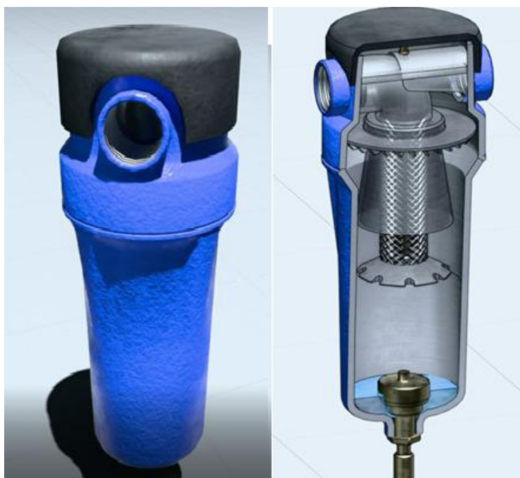
Рисунок 2.5 – Результат моделювання вологомасловідділювача в Blender
