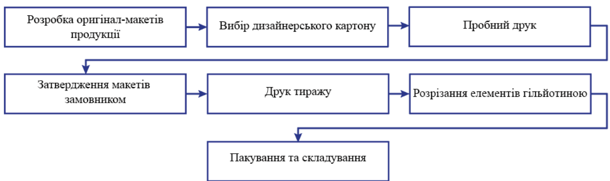
Рисунок 5.2 – Технологічний процес виготовлення поліграфічних елементів
