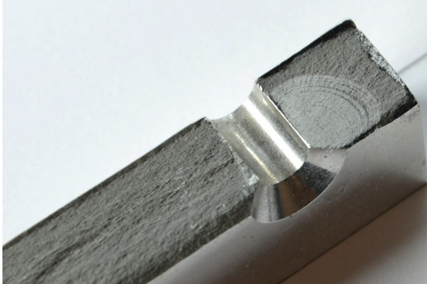
Рисунок 1.3 – Втомне руйнування під дією циклічних навантажень
