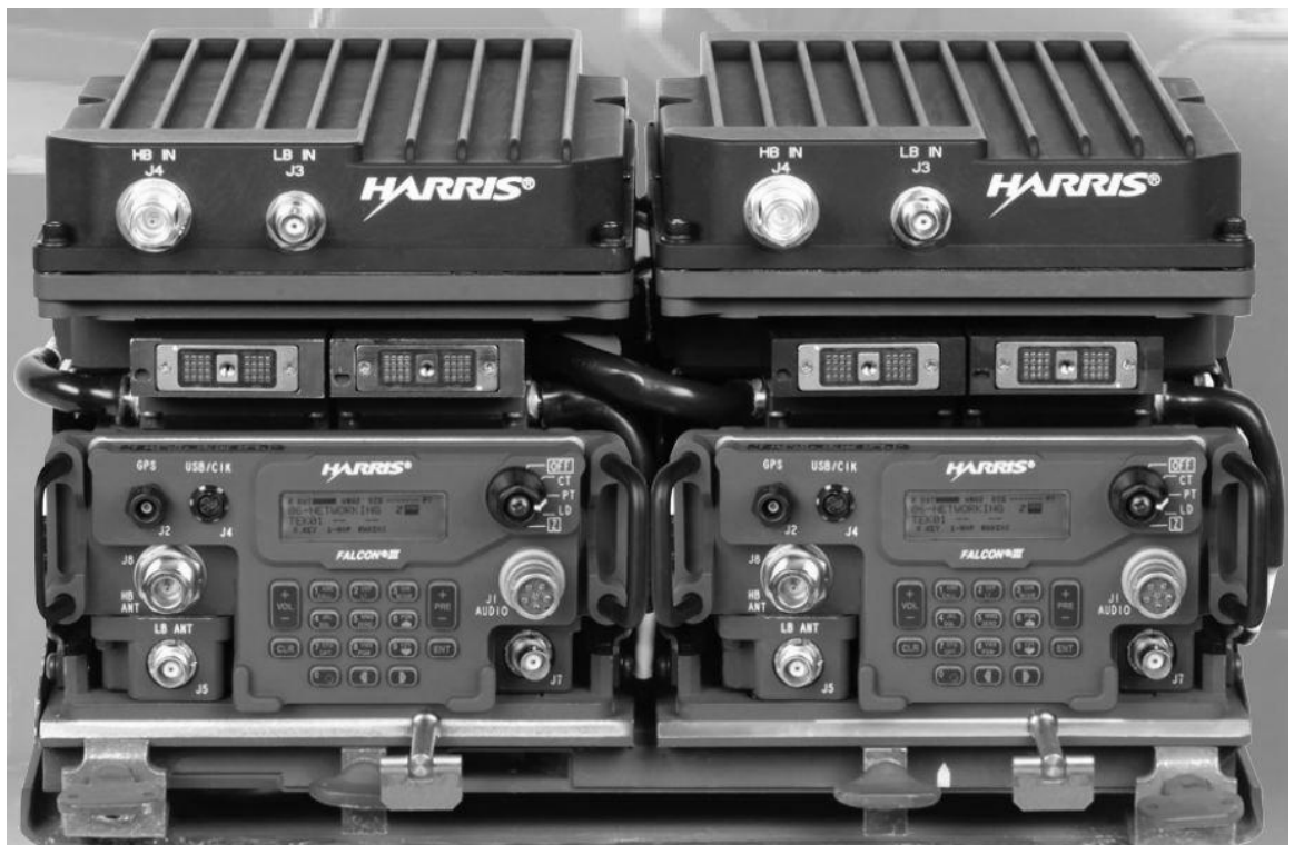
Рис 5.1 – радіостанції RF 7800M-V250 умонтовані у раму з підсилювачем потужності
