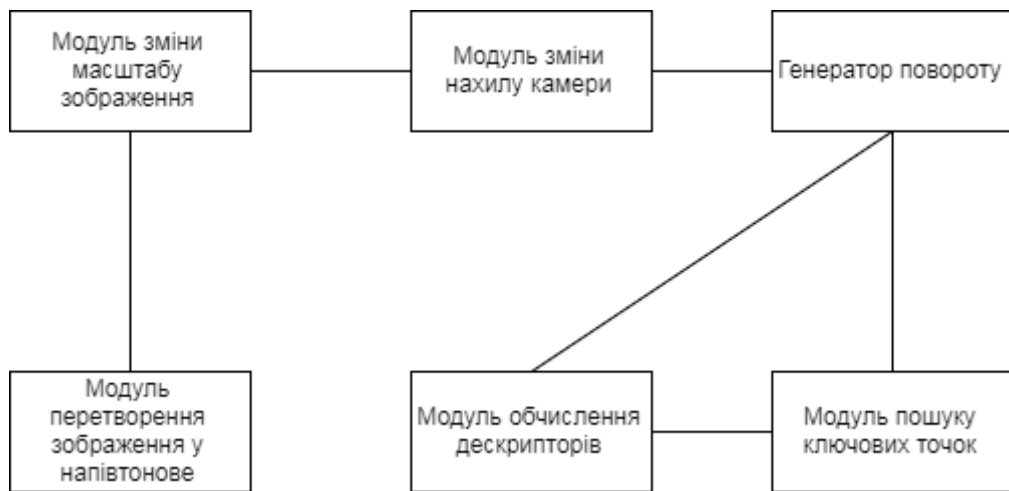
Рисунок 2.10 – Структура модуля обчислення вектора дескрипторів об'єкта
