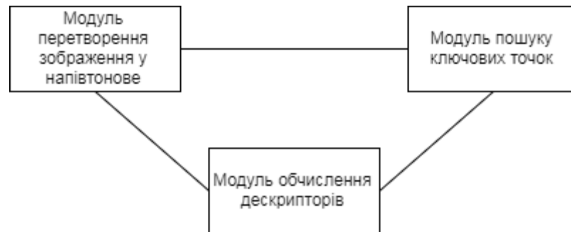
Рисунок 2.12 – Структура модуля обчислення вектора ключових точок кадру
