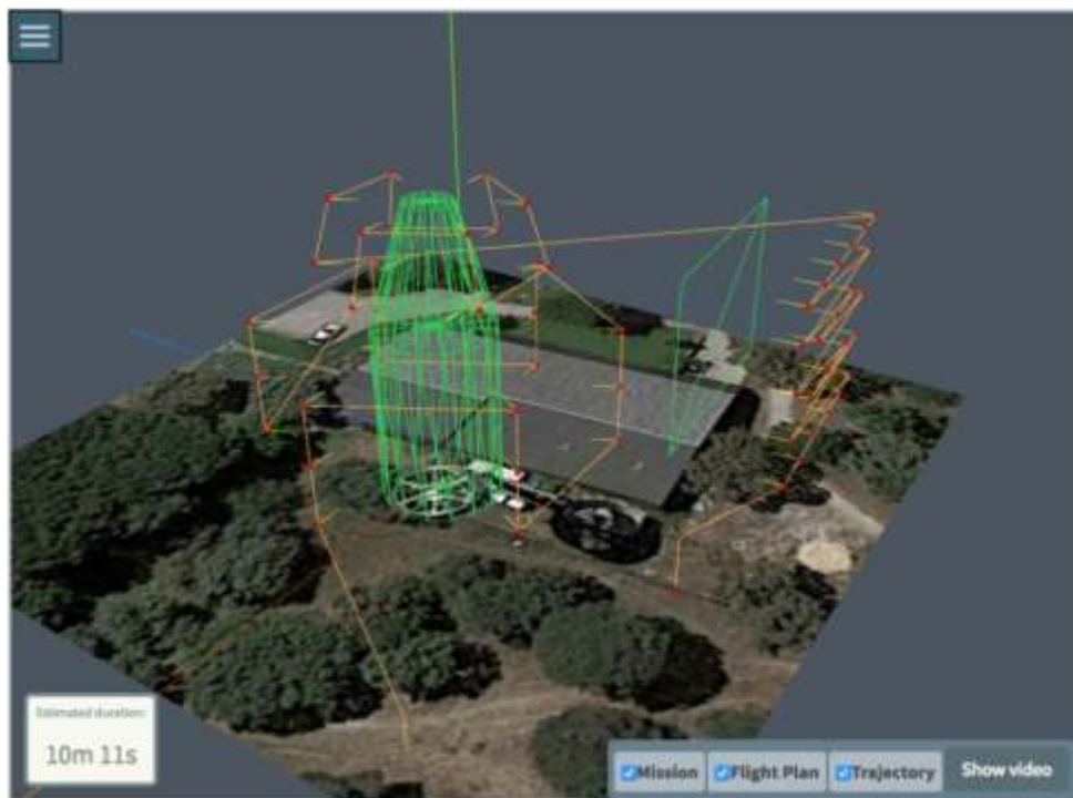
Рисунок 2.11 – Система планування польоту БПЛА з багаточисленними перевірками
