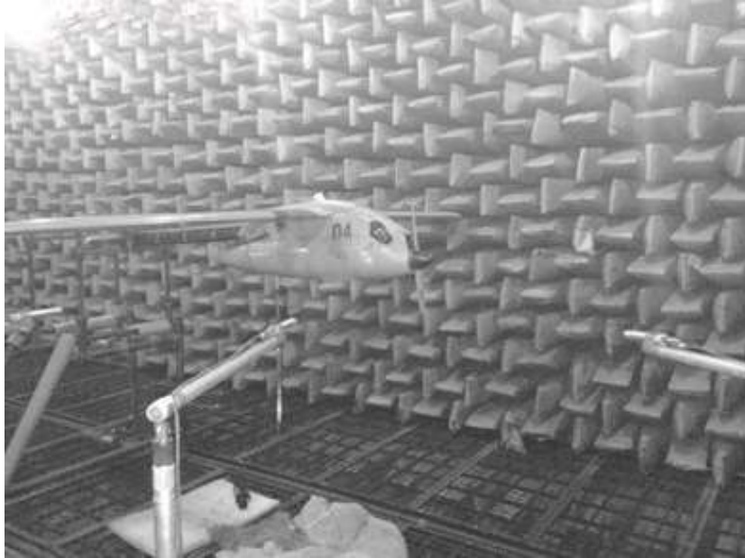
Рисунок 1.7 – Метод вимірювання характеристики спрямованості та АЧХ у заглушеній камері [9]
