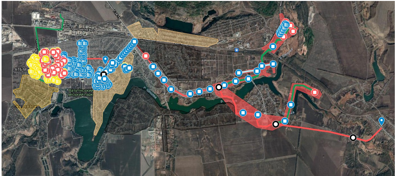
Рисунок 4.6 - Топологічна схема мережі доступу міста Ватутіно на основі технології GERON (вид зі супутника)
