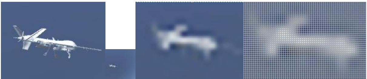
Рисунок 1.3 – Зображення БПЛА MQ-9 Predator з хорошою роздільною здатністю, реально отримане дрібне зображення і його збільшений вигляд в піксельної сітці
