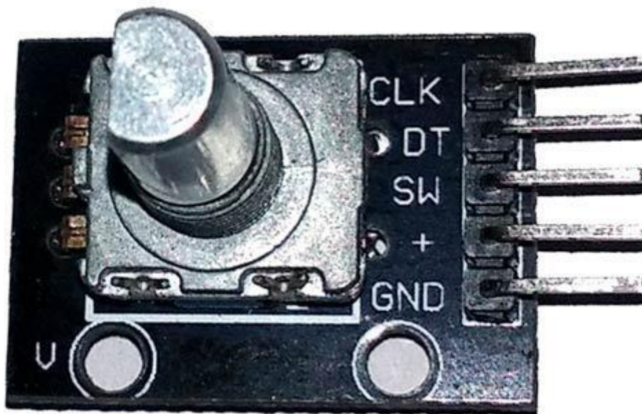
Рисунок 4.7 – Схема контактів інкрементального енкодера KY-040
