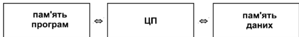
Рисунок 1.5 – Робота із пам'яттю по гарвардському типу
