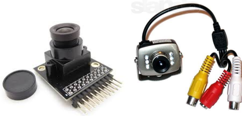
Рисунок 2.2 – Зовнішній вигляд камери з аналоговим та цифровим виходами
