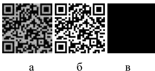
Рисунок 3.24 – Другий метод фільтрації: а – усереднення бінаризованого зображення по кожній клітинці; б – бінаризація зображення; в – різниця між фільтрованим зображенням й оригінальним QR кодом
