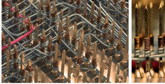
Рисунок 3.61 – Приклад виконання монтажних з'єднань накручуванням
