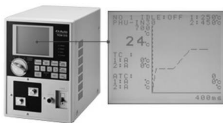
Рисунок 3.54 – Установка для термокомпресійного зварювання AVIO TCW-315 із зображенням термопрофілю на дисплеї
