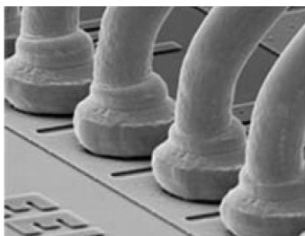
Рисунок 3.52 – Кулька зварного з'єднання встик
