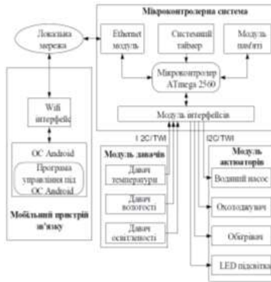
Рисунок 2 – Структура системи управління мікрокліматом складського приміщення
