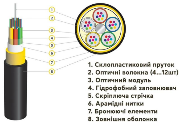
Рисунок 1.9 – Поперечний переріз оптичного кабелю
