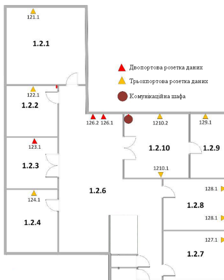
Рисунок 3.2 – Розміщення точок підключення на другому поверсі
