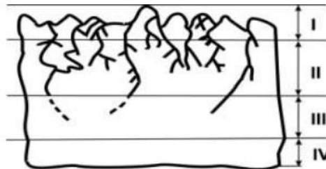
Рисунок 1 – Шари пластини ФК МОЕМС, що зазнають фізико-технологічних впливів та механічних порушень
