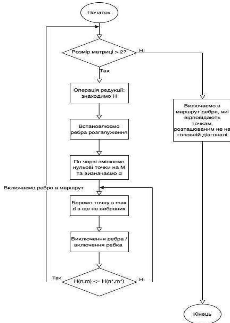
Рисунок 2.3 – Блок-схема методу гілок і меж
