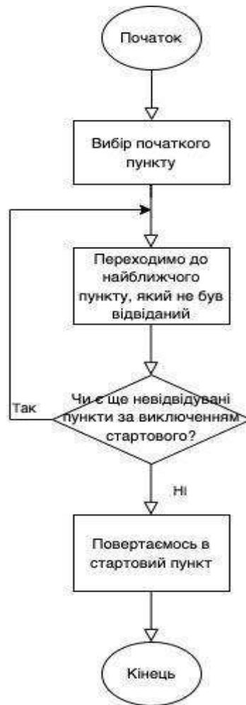
Рисунок 2.2 – Блок-схема методу найближчого сусіда
