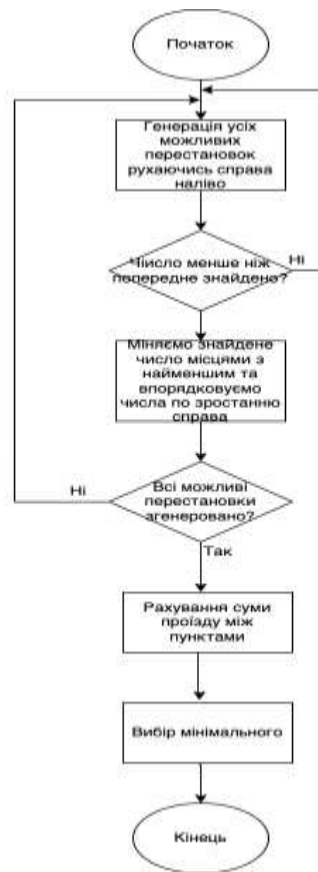
Рисунок 2.1 – Блок-схема методу найближчого сусіда
