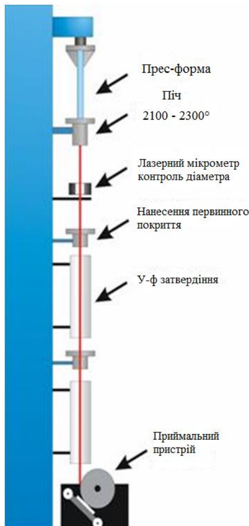
Рисунок 4.5 – Витягування оптичного волокна
