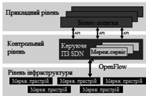
Рис. 1. Концепція технології програмно-конфігурованих мереж
