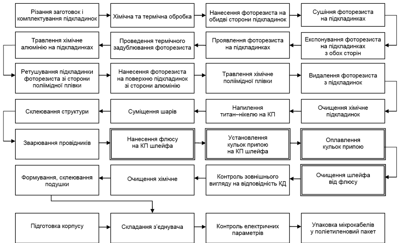
Рисунок 19 – Послідовність операцій ТП виготовлення з'єднувача
