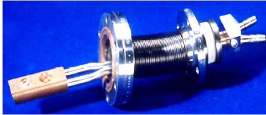
Рисунок 5.18 – 3’ємна мішень з водяним охолодженням прискорювача VARIAN Clinac-18 [20] (режими: фотони 10/18 MeB, електрони 6/9/12/15/18 MeB)
