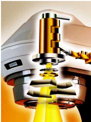
Рисунок 5.18 – 3’ємна мішень з водяним охолодженням прискорювача VARIAN Clinac-18 [20] (режими: фотони 10/18 MeB, електрони 6/9/12/15/18 MeB)
