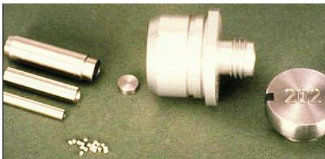
Рисунок 6.4 – Кобальтове джерело та вторинні коліатори в шоломі гамма-ножа (до рис.6.3)
