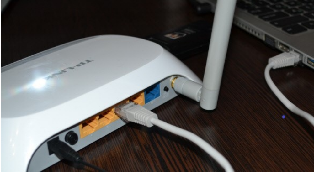
Рисунок 4.2 – Підключення Wi-Fi маршрутизатора TP-LINR TL-MR3220 до комп'ютера за допомогою дроту
