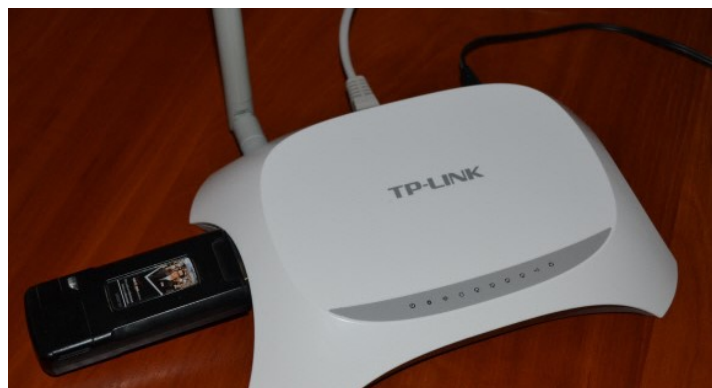
Рисунок 4.1 – Підключення USB модема до Wi-Fi маршрутизатора TP-LINK TL-MR3220
