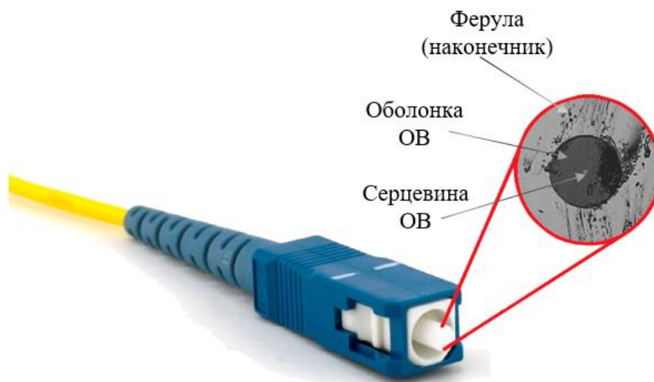
Рисунок 3.4 – Фєрула з оптичним волокном у роз'ємі SC-типу
