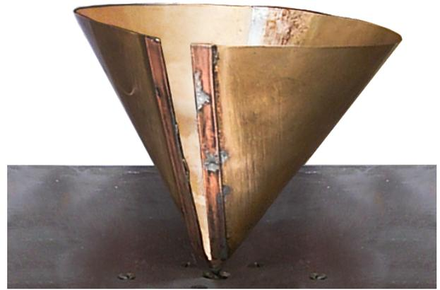
Рис. 4. Фото конусной антенны с продольной щелью над экранирующей поверхностью.
