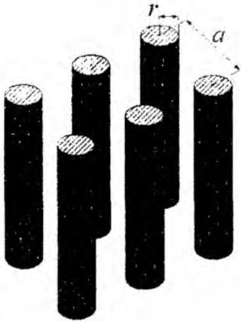
Рис. 3. Массив тонких металічних стрижнів
