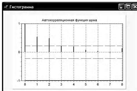
Рис. 4. Выборочная автокорреляционная функция шума
