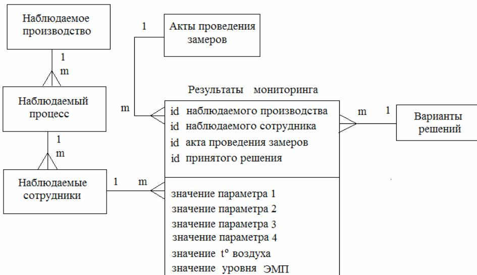
Рис. 4. Обобщенная концептуальная схема хранилища данных информационно-аналитической системы управления безопасностью производства
