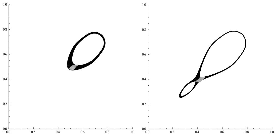
Рис. 12. Эволюция плоского элемента при первом режиме перемешивания
