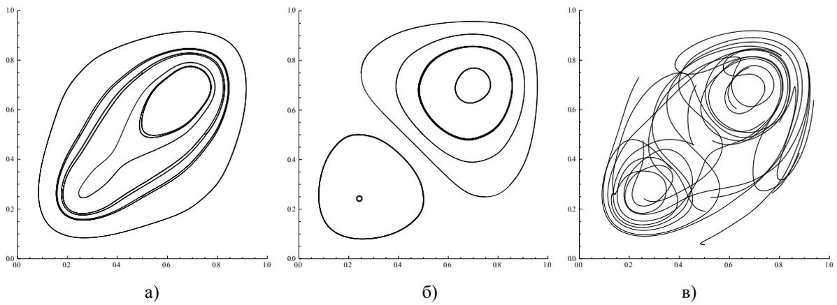
Рис. 8. Фазовые траектории при первом (а), втором (б) и третьем (в) режимах перемешивания
