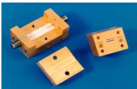
Рис. 2. Микрополосковый резонатор, изготовленный на основе  $YBa_2Cu_3O_{7-x}$
