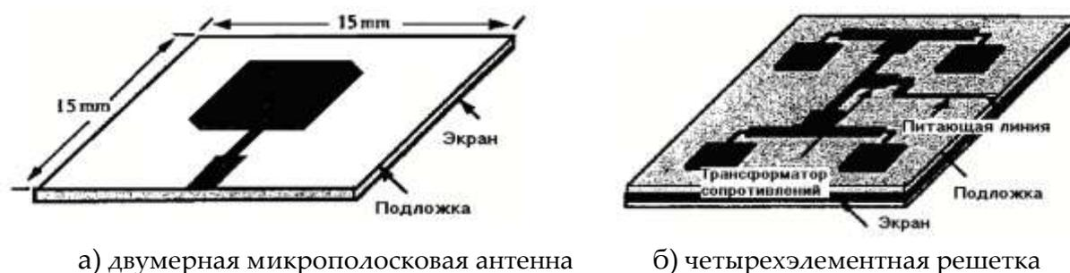
а) двумерная микрополосковая антенна
