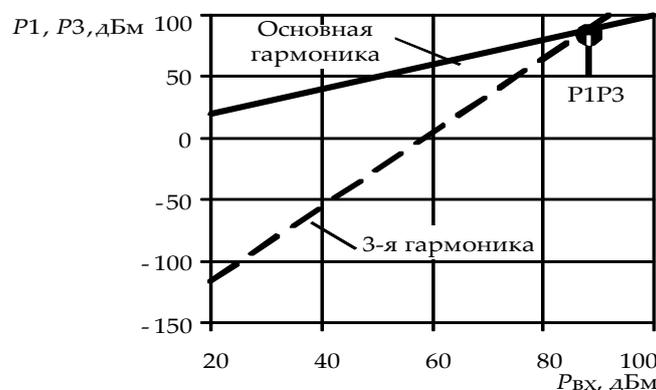
Рис. 27. Зависимость мощности 1-ой и 3-ей гармоник от мощности входного воздействия
