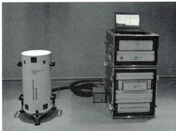
Рис. 3. Портативный квантовый гравиметр, производимый компанией Muquans.
