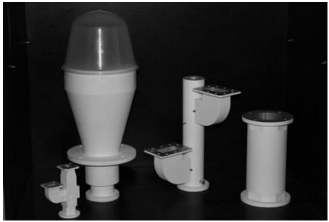
Рис. 11 Опромінювальний модуль: рупор, ортомодовий перетворювач С-/Ku-, поляризаційна секція;
