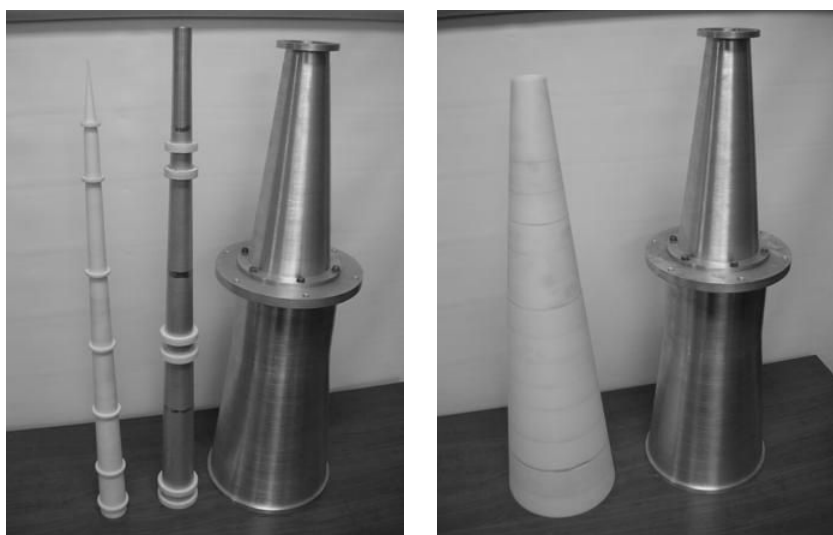
Рис. 6 Коаксіальний рупор з частковим діелектричним заповненням (складові частини)
