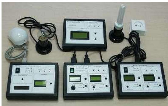
Рис.1. - Модель тестової платформи «розумного» будинку
