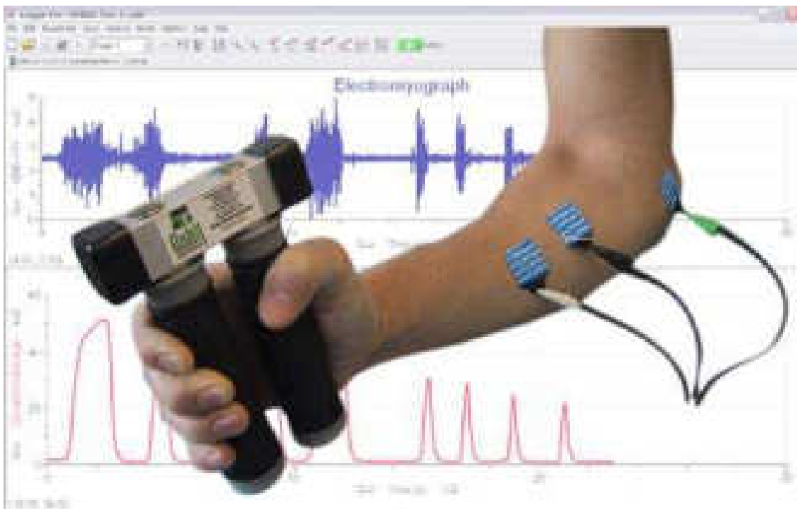
Рисунок 4.17 – Метод реєстрації скелетного м'язу людини при різній силі скорочення; II – невелике скорочення м'язу; III – максимальне скорочення м'язу
