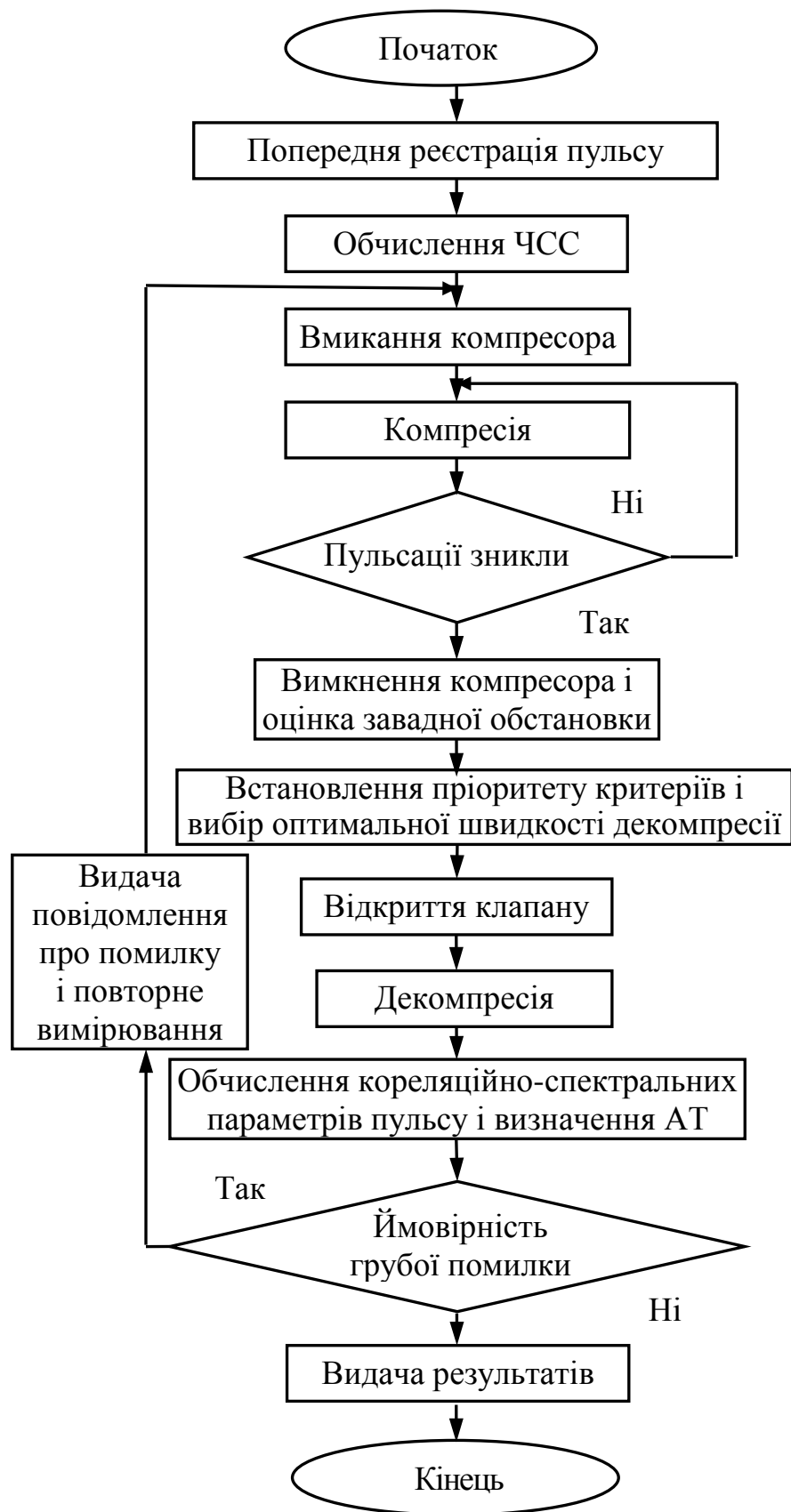
Рисунок 2.15 – Алгоритм роботи системи вимірювання АТ
