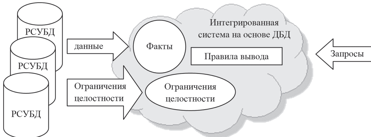
Рис. 5. Схема интеграции реляционных СУБД на основе ДБД
