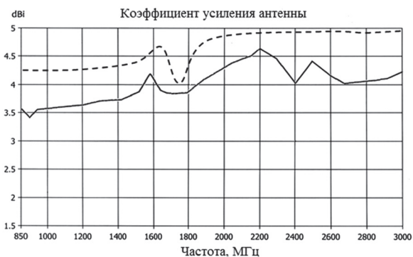
Рис. 3. Зависимость коэффициента усиления антенны от частоты
