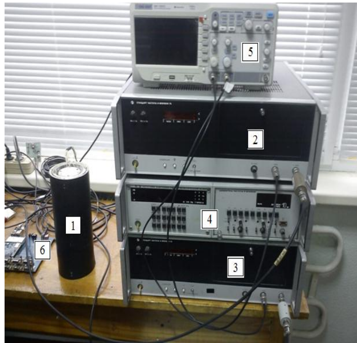
Рис. 3. Зовнішній вигляд експериментальної установки (групового еталону), яка складається з двох КМЧ та прототипу КГВЧ
