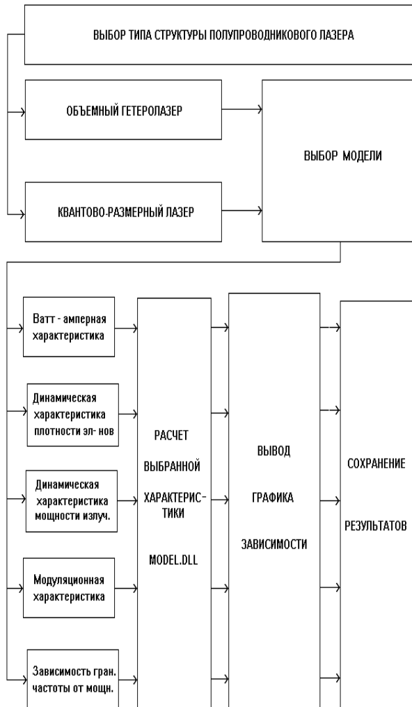
Рис. 1. Структурная схема программного пакета LasDun
