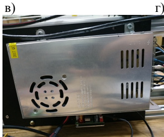
Рис. 3. Електронна частина гравера: а) LCD екран; б) плата керування на основі ArduinoMega; в) драйвер лазерного модуля; г) кінцеві вимикачі; д) блок живлення.
