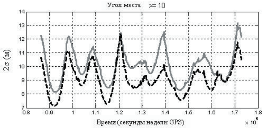
Рис. 3. Точность определения горизонтальной составляющей Юг – Север: — задача без дополнительного условия; --- задача с дополнительным условием
