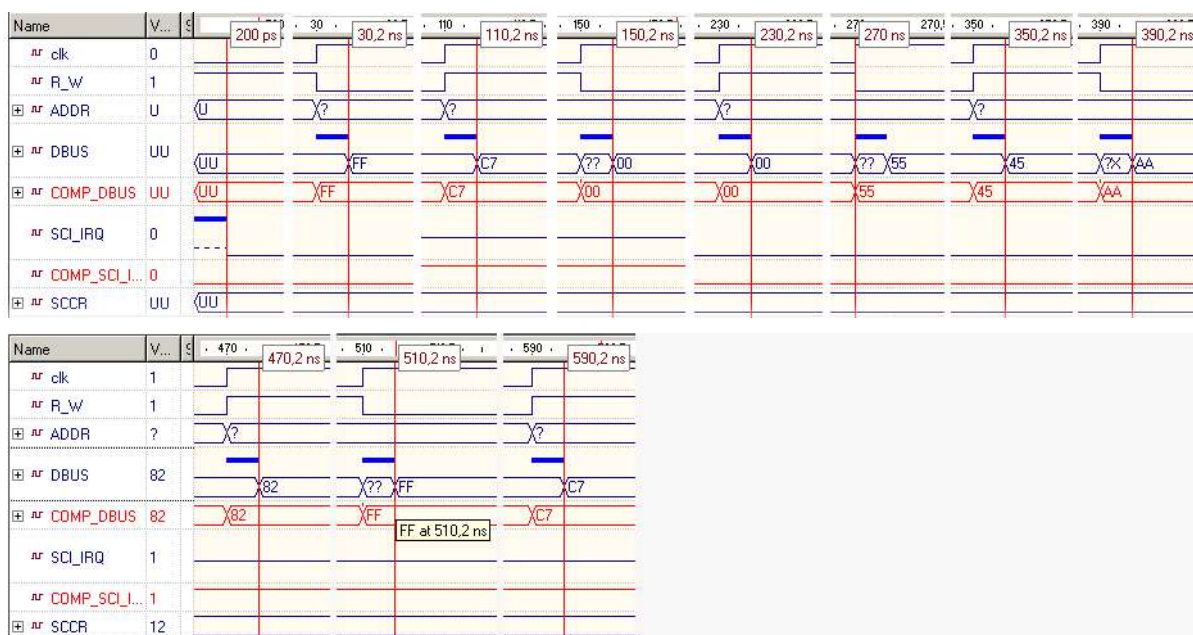
Рисунок 12.34. Фрагмент сравнения временных диаграмм, полученных в результате моделирования функциональной модели и синтезированной схемы
