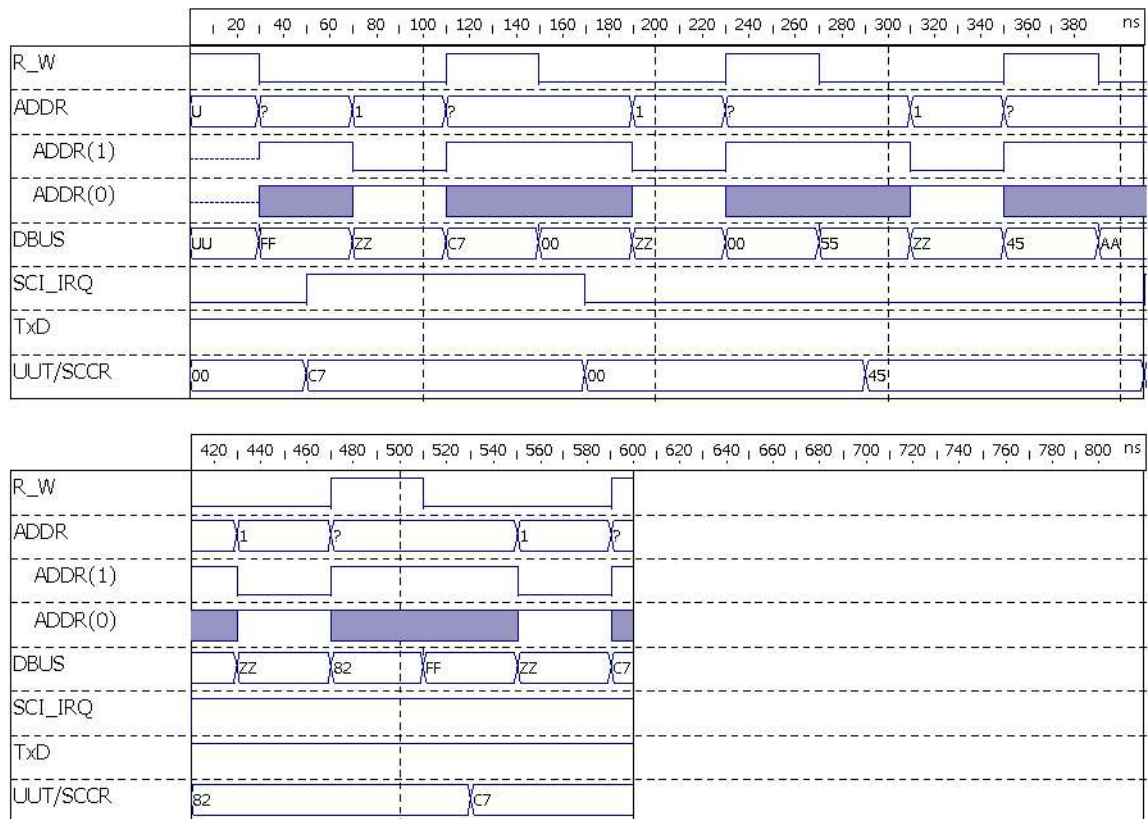
Рисунок 12.21. Временные диаграммы тестирования модуля UART в режиме обмена информацией между шиной DBus регистром SCCR
