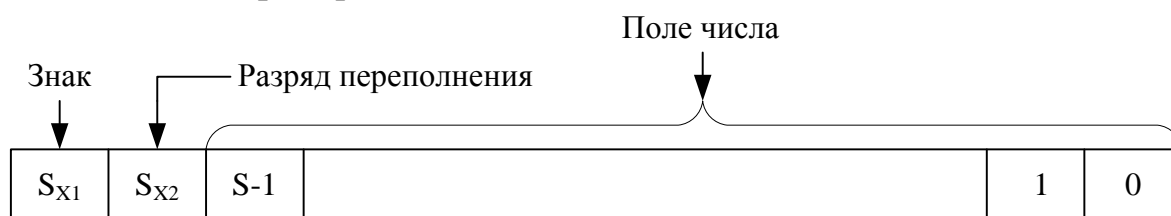
Рисунок 2.34 – Формат двоичного знакового числа с использованием модифицированного кода
