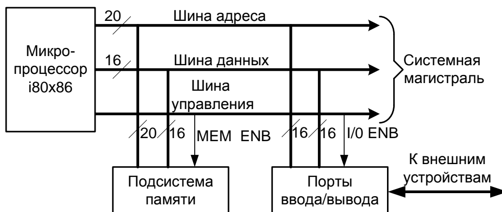
Рисунок 3.1 – Структурная схема вычислительной системы на базе МП i80x86
