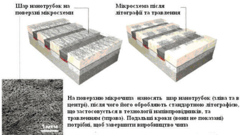
Рис. Д8.13. Процес виробництва чипа
