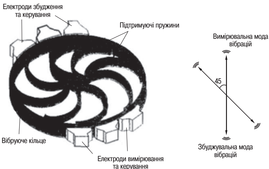
Рис. 5.14. Структура гіроскопа з вібруючим кільцем
