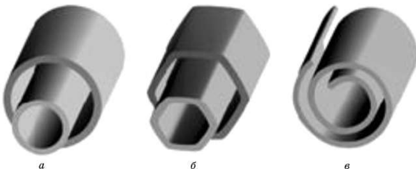
Рис. 3.7. Моделі поперечних структур багатошарових нанотрубок: а — мотрійка; б — шестигранна призма; в — згорток
