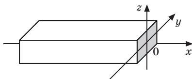
Рис. 2.1. Система координат при розгляді деформацій згину балки
