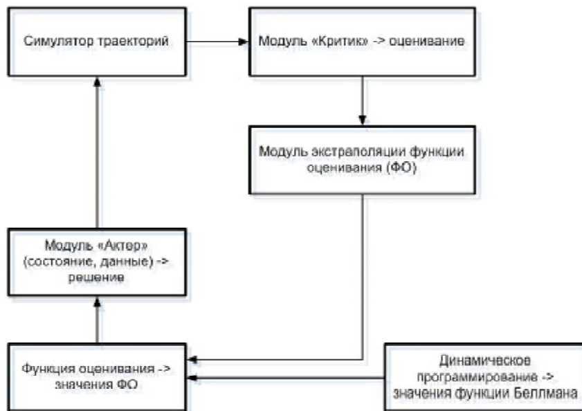
Рис. 2. Комбинированная схема формирования функции оценивания
