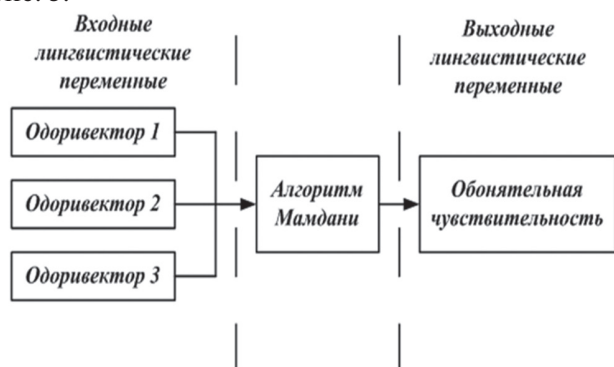
Рис. 3. Структура модели нечеткого вывода «Ольфактометрия»
