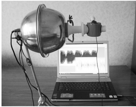
Рис. 5. Зовнішній вигляд системи для пульмофонографічних досліджень
