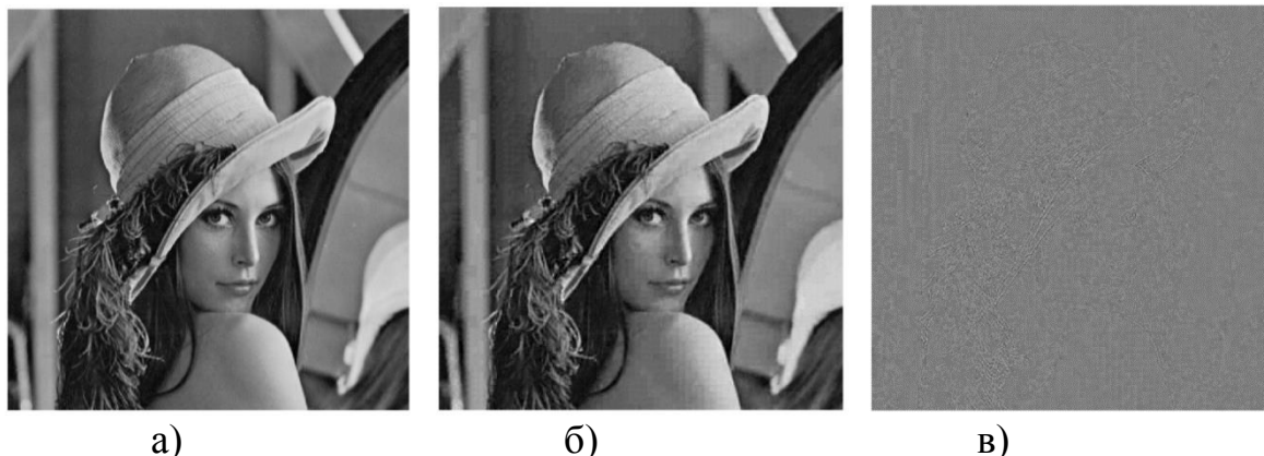
Рисунок 5 – Приклад стискання зображення: а) – оригінальне зображення, б) – стиснене зображення, в) – поверхня похибки
