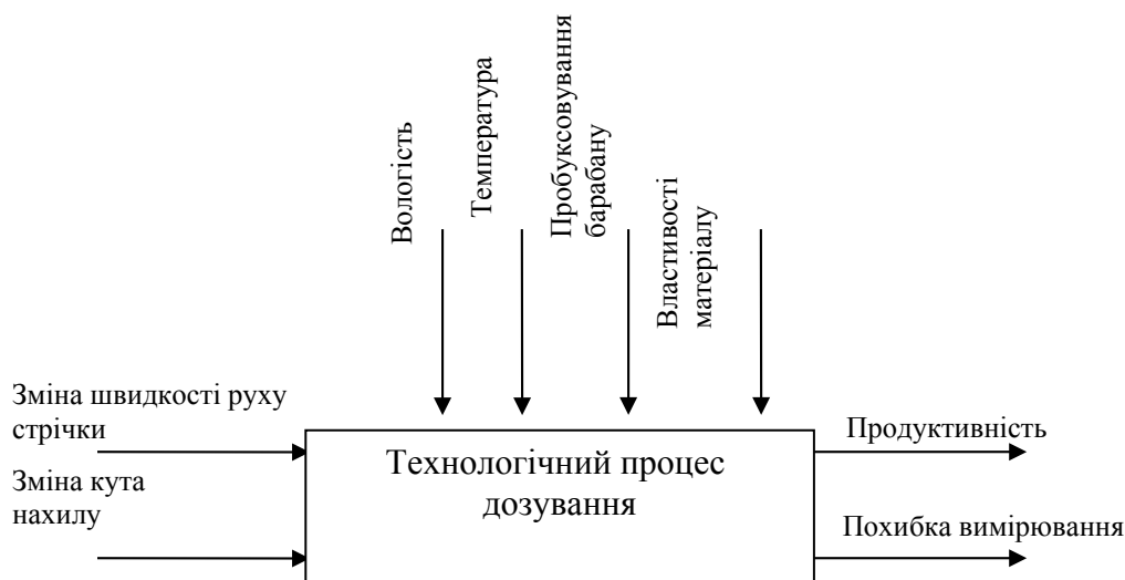
Рис. 5. Схема технологічного процесу дозування як об'єкта керування
