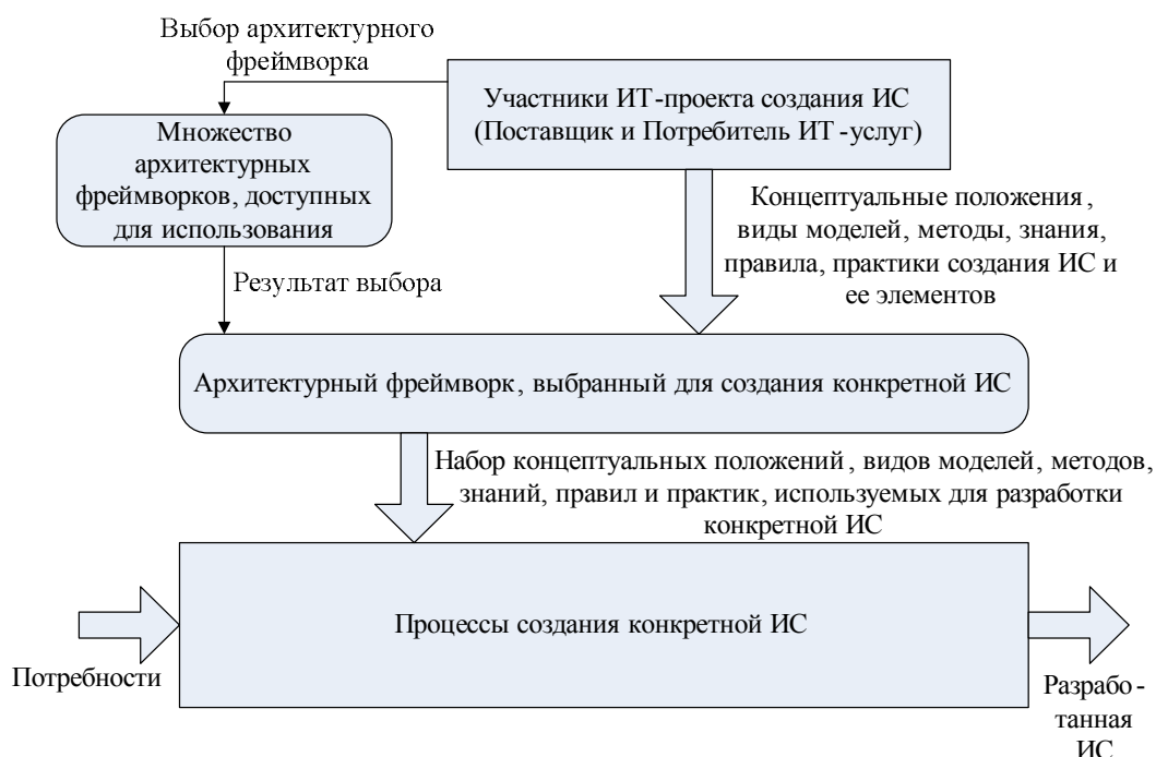
Рисунок 4.1 – Место архитектурного фреймворка в процессах создания информационной системы
