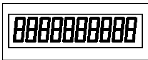
Рисунок 3.1 – Схематическое изображение передней панели 10-позиционного цифрового индикатора
