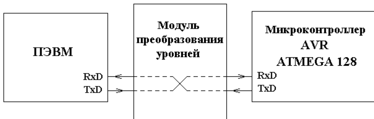
Рисунок 5.1 – Обобщенная функционально-структурная схема соединения двух устройств с помощью интерфейса RS-232C
