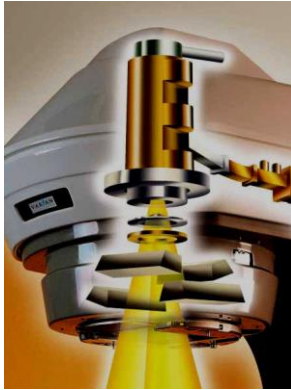
Рисунок 2.3 – Будова опромінювача лінійного прискорювача 6 MeV та схема рухів терапевтичної системи
