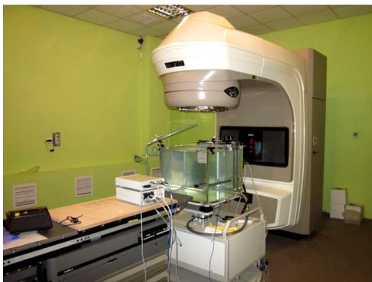
Рисунок 4.5 – Вимірювальний комплекс для дослідження дозиметричних характеристик лінійного прискорювача електронів Clinac 600C
