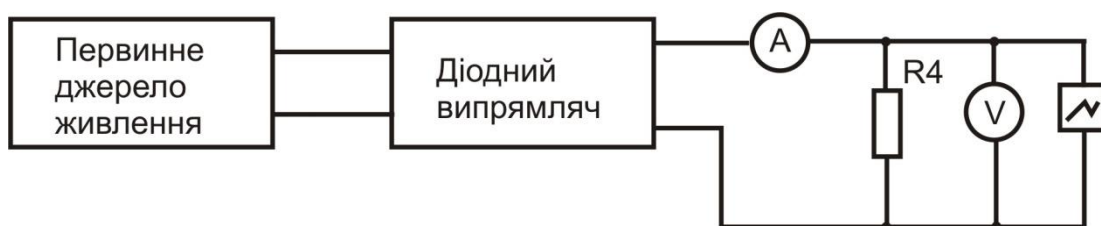
Рисунок 6.7 — Схема дослідження випрямлення напруги діодним випрямлячем
