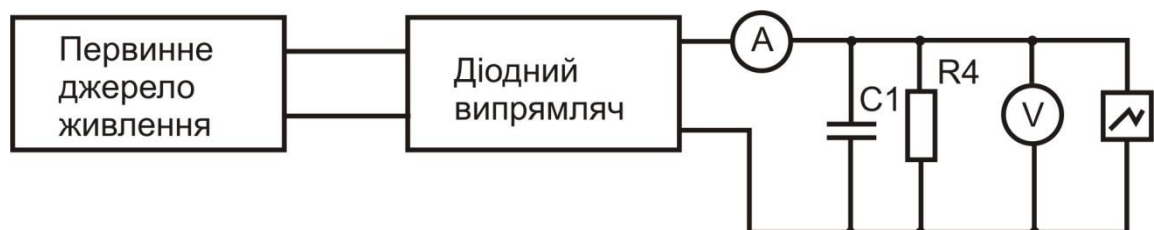
Рисунок 6.9 — Модифікована схема дослідження впливу ємності на випрямлення напруги
