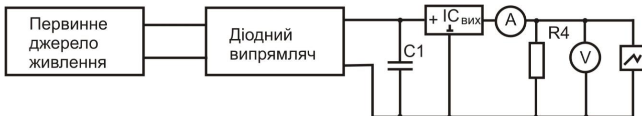
Рисунок 6.13 — Схема дослідження випрямлення напруги інтегральним стабілізатором
